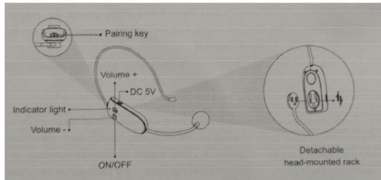
Le réglage d'usine du microphone sans fil a été appareillé avec succès vous pouvez l'utiliser directement. Si le microphone n'a pas de son ou qu'il s'est déconnecté vous devez le coupler manuellement de la manière suivante :
